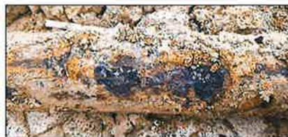
**Photo 1 : Conduite en fonte ductile Ø125mm remplacée lors de l'intervention du 15 novembre 2022 – observation de corrosion sur la conduite**
