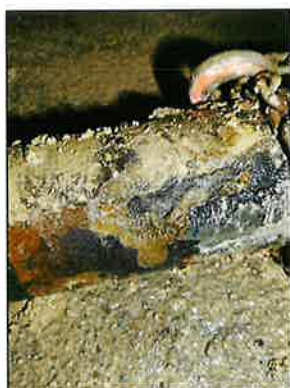
Etat de la conduite : corrosion externe de la fonte
